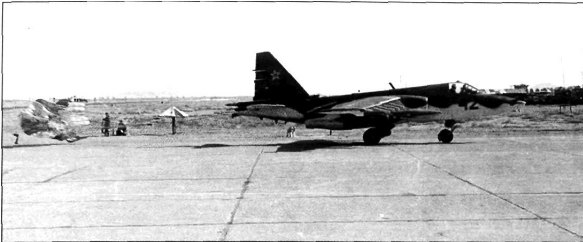
В разреженном и жарком воздухе высокогорья посадку постоянно приходилось выполнять с тормозным парашютом
