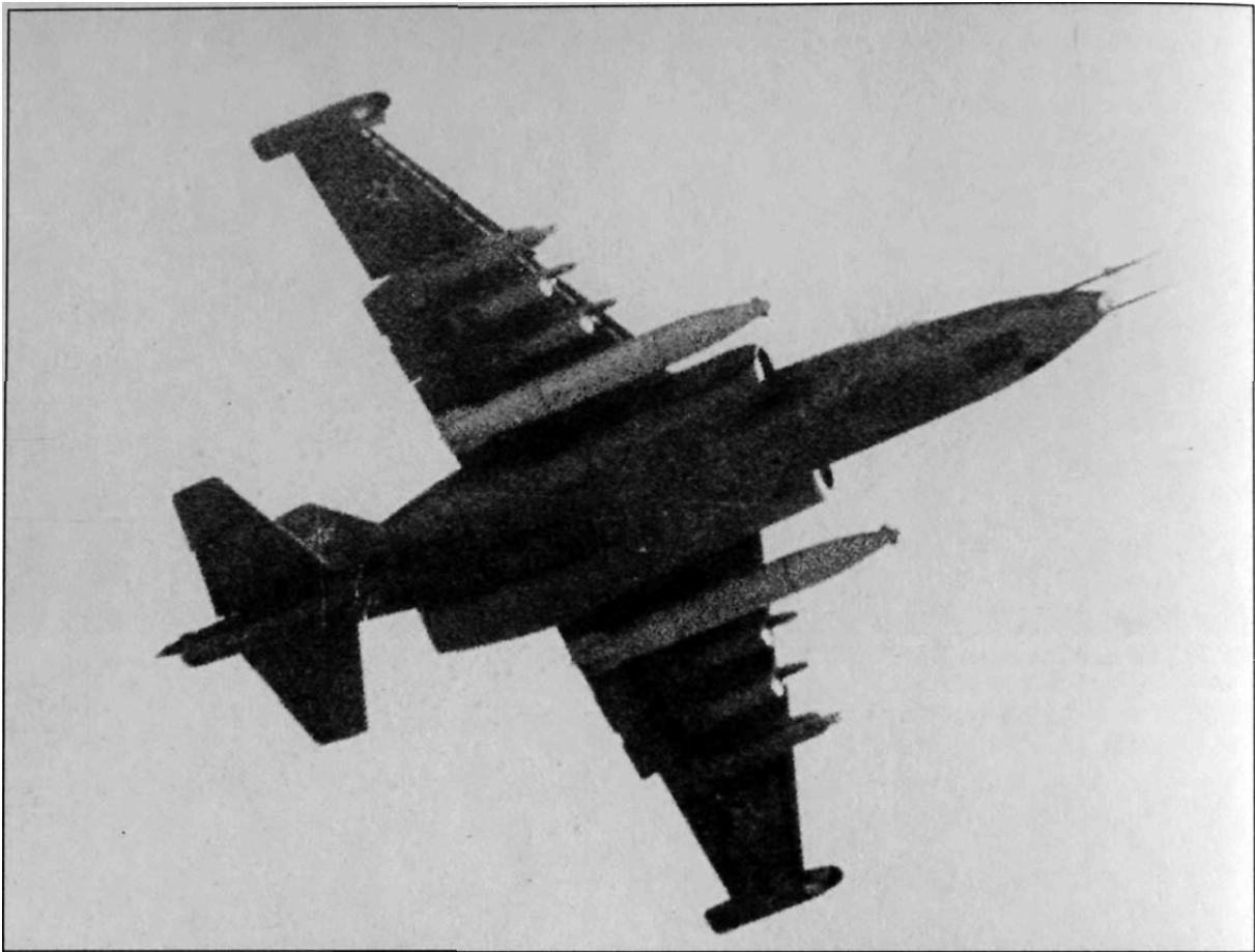
Су-25 несет набор подвесок из пары ПТБ-800, четырех 250-кг бомб и двух снарядов С-24
