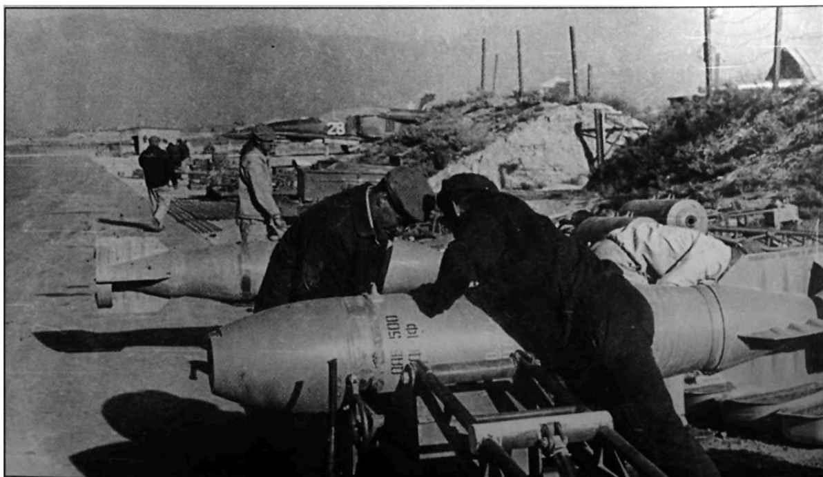
Группа вооружения готовит к подвеске дымовые бомбы ДАБ-500. При задержке с подвозом боеприпасов и они шли в дело в роли зажигательных
