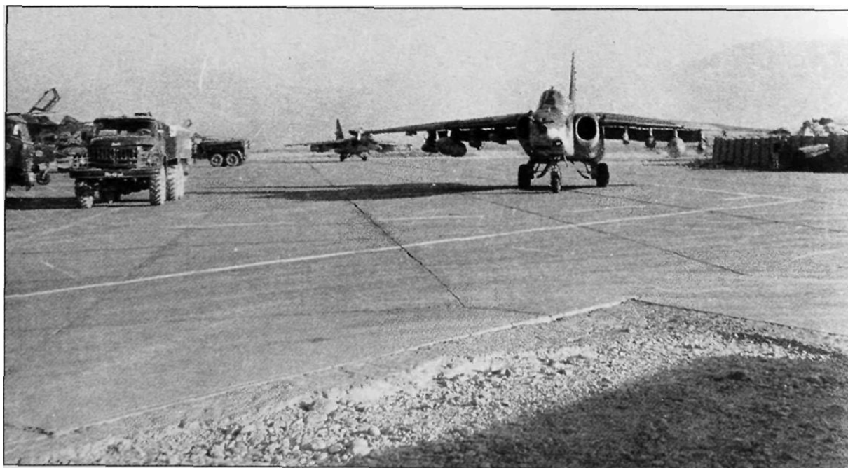
Под крылом штурмовика - катапультные установки АКУ-58 для тяжелых управляемых ракет Х-29
