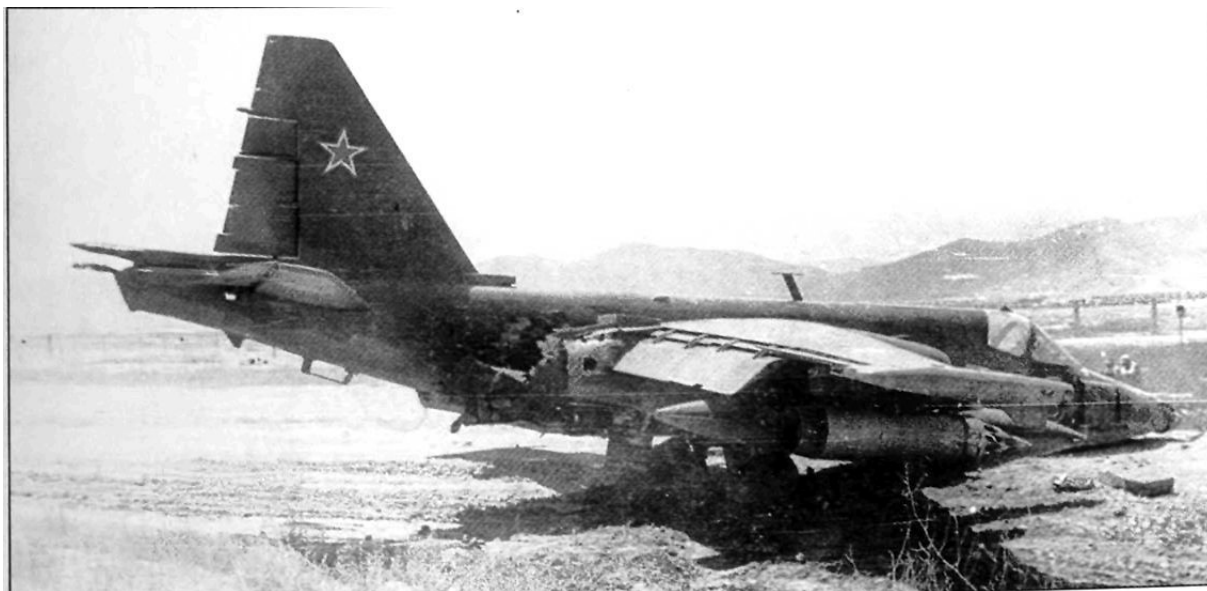
Последствия поражения «Стингером»: самолет А. Обьедкова едва дотянул домой, выполнив аварийную посадку в Кабуле
